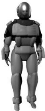
Une CM est conçue pour protéger celui qui la porte contre les températures extrêmes et la basse pression qui règnent à la surface de Mars. Chaque tenue comprend un casque et une réserve standard de huit heures d'oxygène. La tenue possède une batterie intégrée qui alimente le système de contrôle de l'environnement servant à réguler la température interne, et une seconde batterie d'une capacité de huit heures (en utilisation normale).
