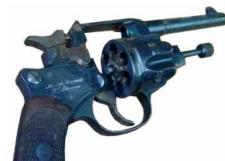
Ce type de système de rechargement est le plus courant sur les revolvers. Un mécanisme permet de faire basculer le barillet sur le côté, généralement à droite. On peut, rapidement faire tomber les étuis vides avant de recharger chaque chambre une par une. Sauf indiqué dans la description de l'arme, on ne peut interchanger un barillet vide avec un barillet plein.
