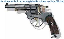
Descriptif: Le Lebel M1873, originellement fabriqué sous l'appellation «Chamelot-Delvigne», est un puissant revolver grâce à sa munition de 11 mm. Il est d'une précision moyenne et reste une arme assez fragile. De plus, son système de chargement est lent (comme toutes les armes de cette époque) mais reste relativement fiable. Il connut un certain succès à sa sortie et devint une arme assez courante en France.
